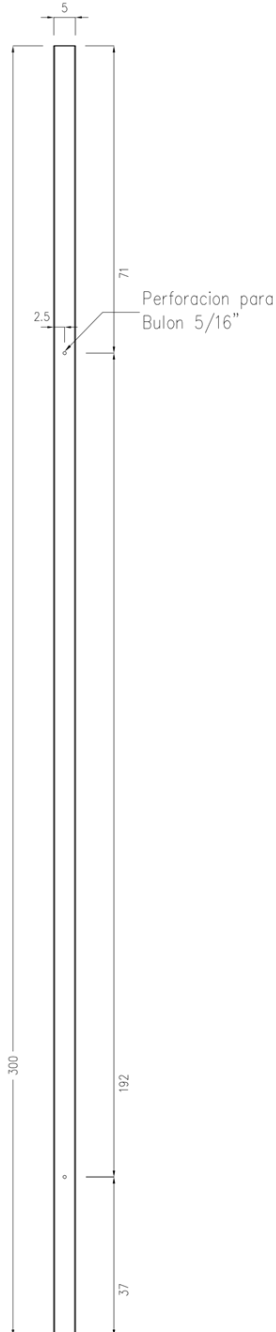
VISTA FRONTAL 2 PERFORACIONES POR CAÑO
