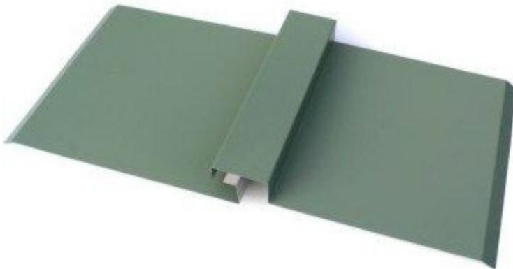
La siguiente imagen es a modo de ilustración, el oferente deberá diseñar una cumbrera o cupertina que garantice el libre movimiento de las juntas y no permita el ingreso de las aguas.- Tipo : Solape libre. Los solapes entre remates serán de 150 mm como mínimo y se interpondrá una junta de sellado que garantice la estanqueidad.
