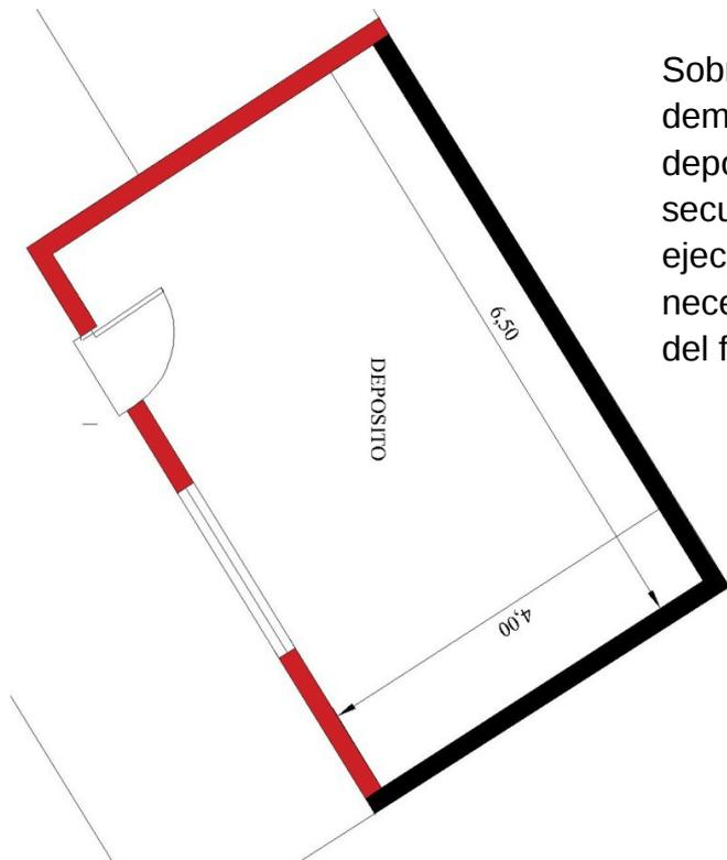
Sobre el patio posterior, se demolerá un sector del actual depósito de elementos secuestrados y se procederá a la ejecución de los paramentos necesarios para el cerramiento del frente del nuevo depósito.
