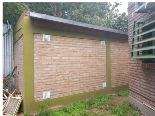
La cubierta, será de chapa galvanizada. Tendrá aislación térmica "Isolant", o similar calidad. Con terminación de aluminio simil madera. -
